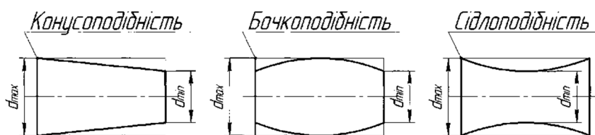
Рисунок 9.5 – Види відхилю профілю повздовжнього перетину
