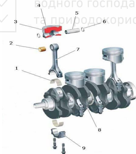
Рис. 7. Кривошипно-шатунний механізм: 1-вкладиш шатунного підшипника; 2-втулка верхньої головки шатуна; 3-поршневий кільця; 4-поршень; 5-поршневий палець; 6-стопорне кільце; 7-шатун; 8-колінчатий вал; 9-кришка шатунного підшипника
