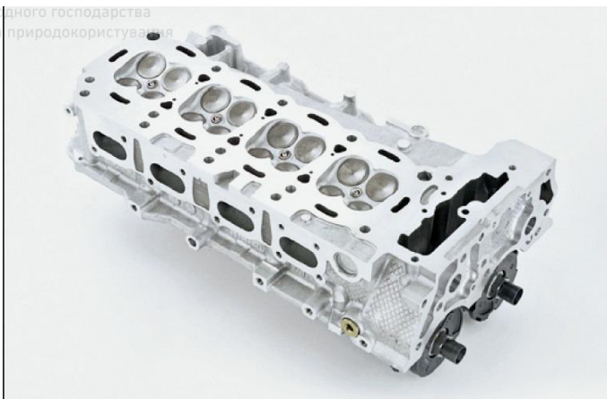
Рис. 8. Головка блока чотирьохциліндрового рядного двигуна із двома розподільчими валами, чотири клапана на циліндр
