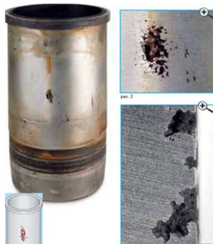
Рисунок 4.1 – Дефекти гільзи блока циліндрів
