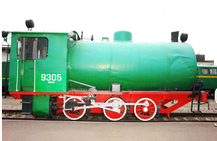
Рисунок 4.6 – Загальний вигляд безтопкового локомотива
