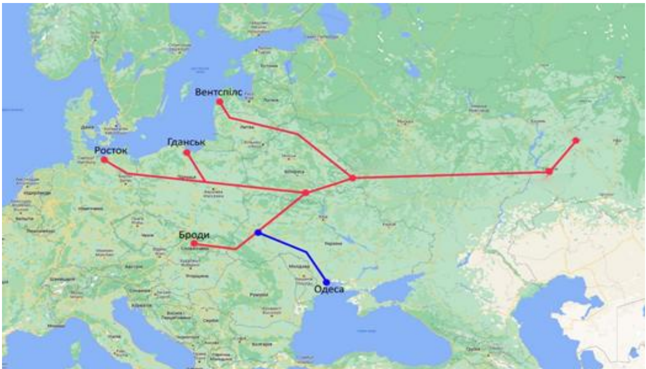
Рисунок 4.17 – Схема нафтопроводу «Дружба» (червоний колір) та нафтопроводу Одеса – Броди (синій колір)
