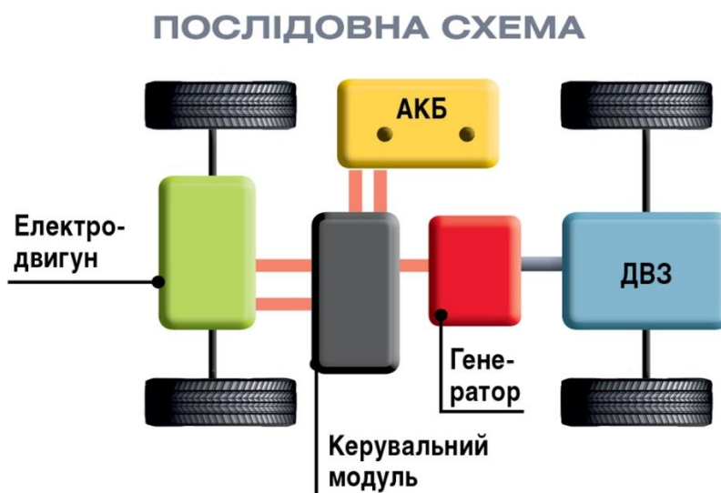
Рисунок 4.11 – Принципова схема послідовного гібридного автомобіля
