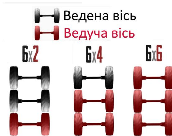
Рисунок 4.8 – Основні осьові формули вантажних автомобілів
