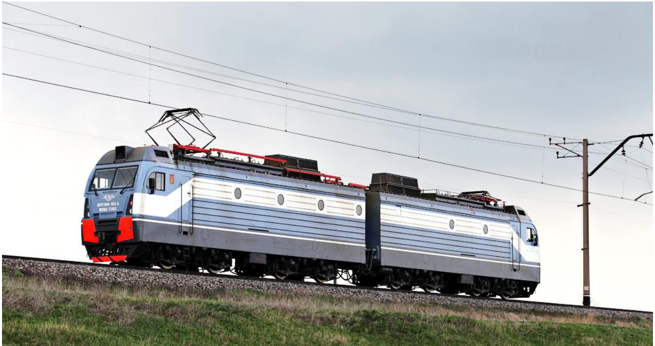
Рисунок 4.4 – Загальний вигляд електровоза постійного струму ВЛ11М6
