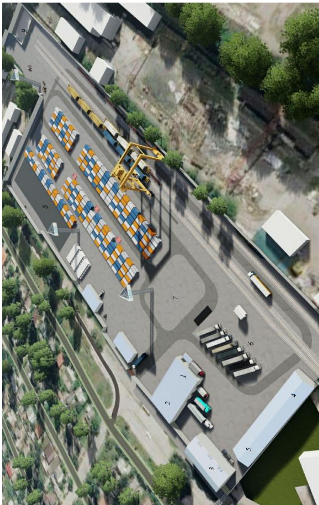
Рис. 7.24. Схема малого залізнично-автомобільного терміналу:
