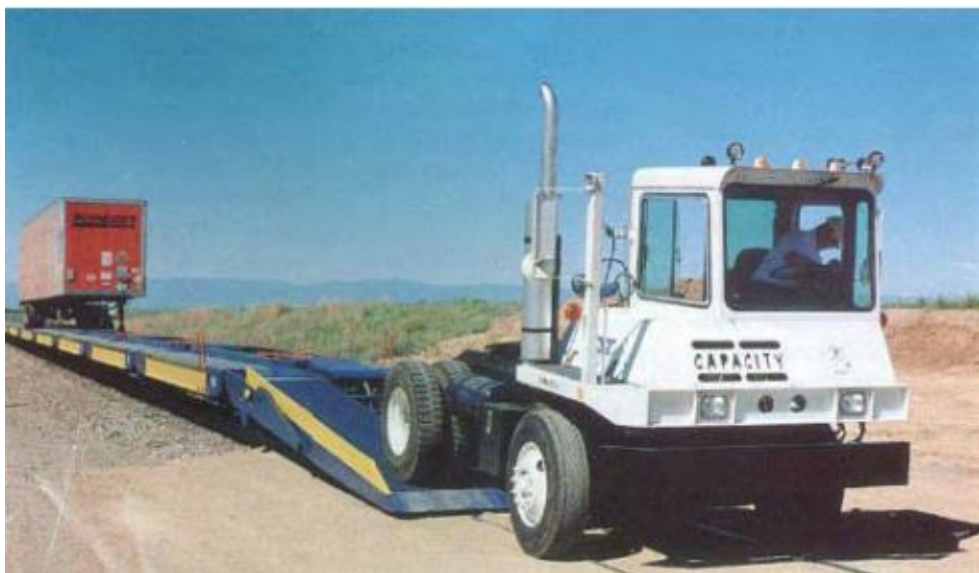
Рис. 7.17. Виконання вантажних операцій з модулем Iron Highway
