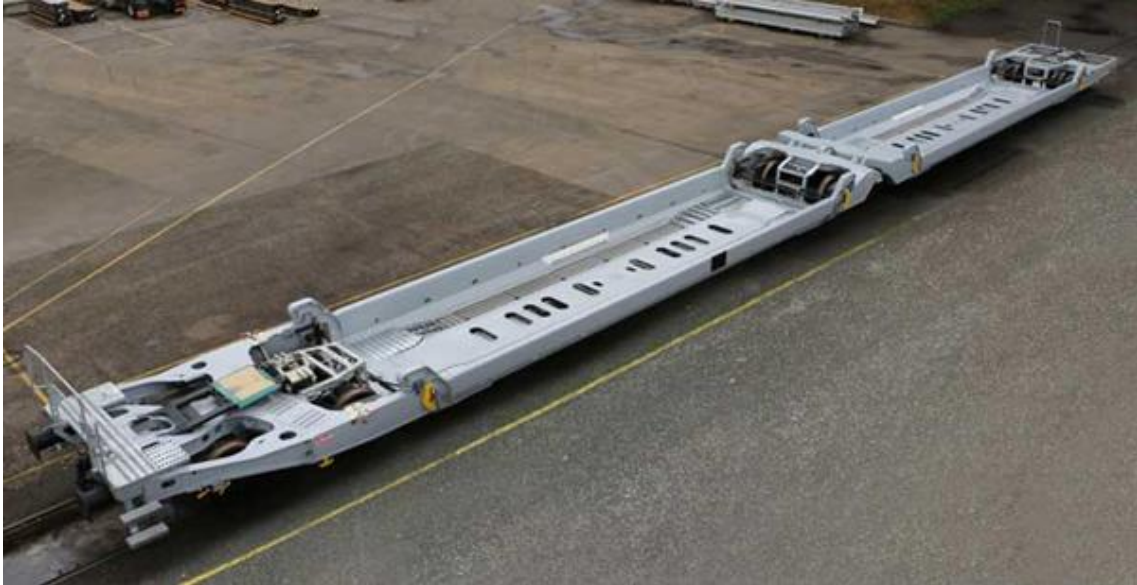
Рис. 7.14. Подвійний зчленований вагон Modalohr
