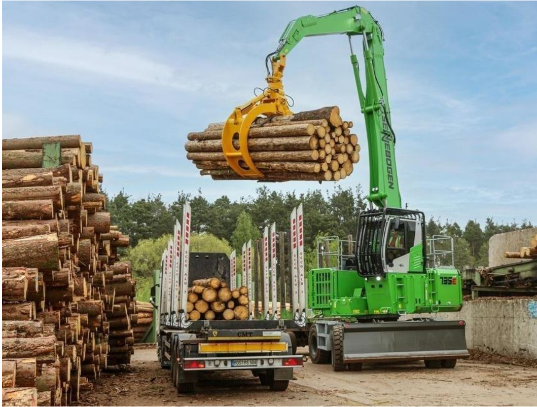
Рис. 7.6. Навантаження лісоматеріалів колісним навантажувачем із спеціальним захватом
