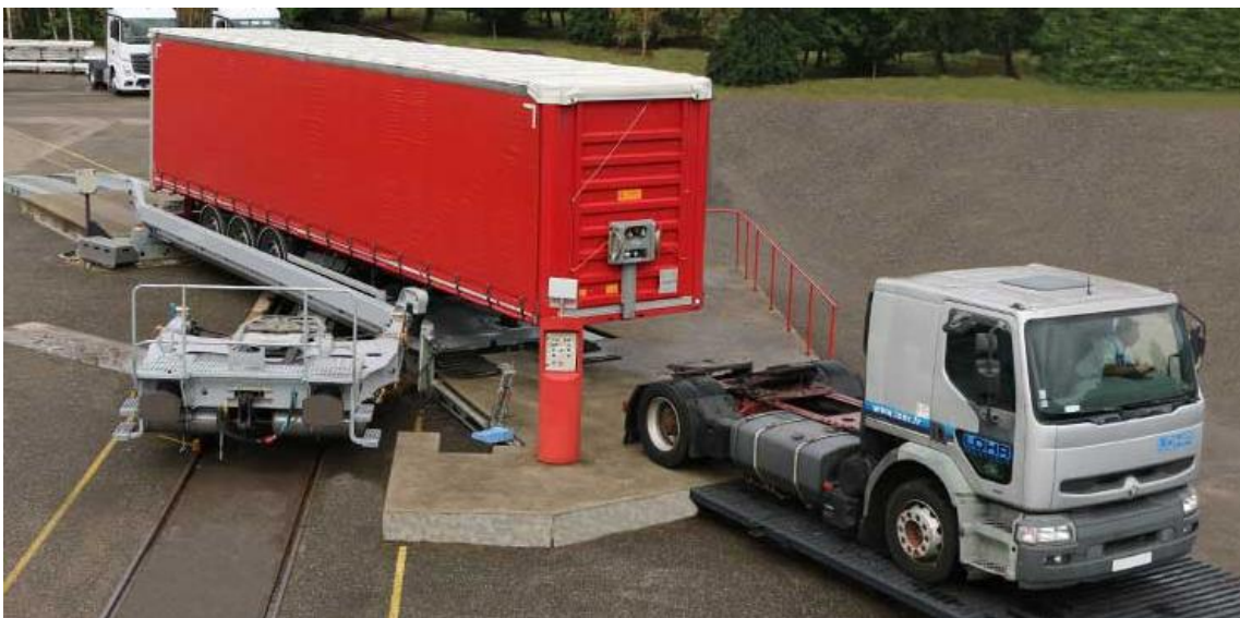
Рис. 7.15. Положення поворотної платформи Modalohr у вантажному положенні
