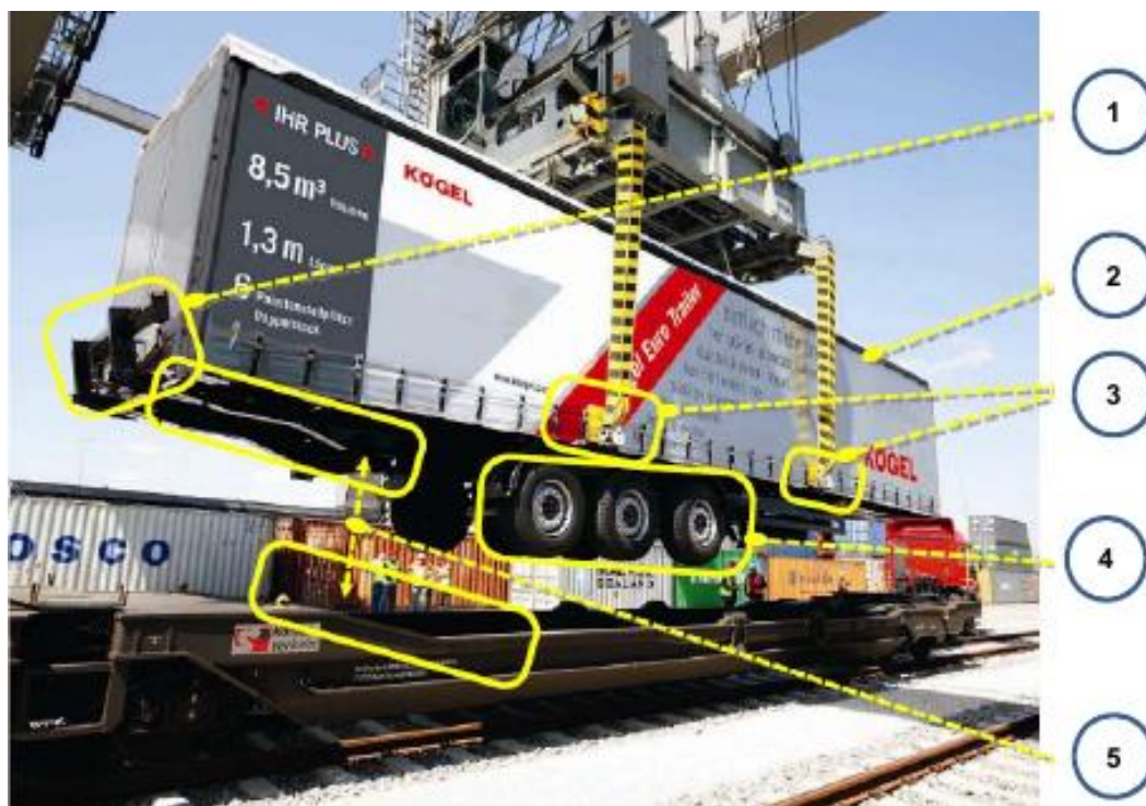
Рис. 7.10. Конструктивні особливості напівпричепа, придатного до вертикального перевантаження:
