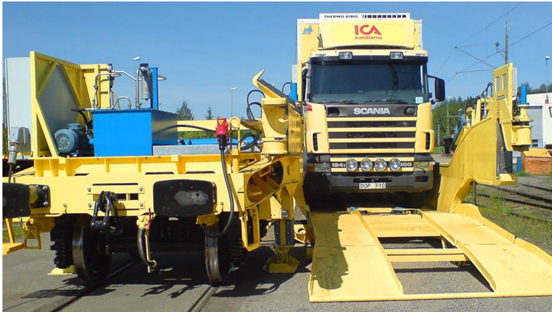
Рис. 7.19. Виконання вантажних операцій з вагоном Flexiwaggon
