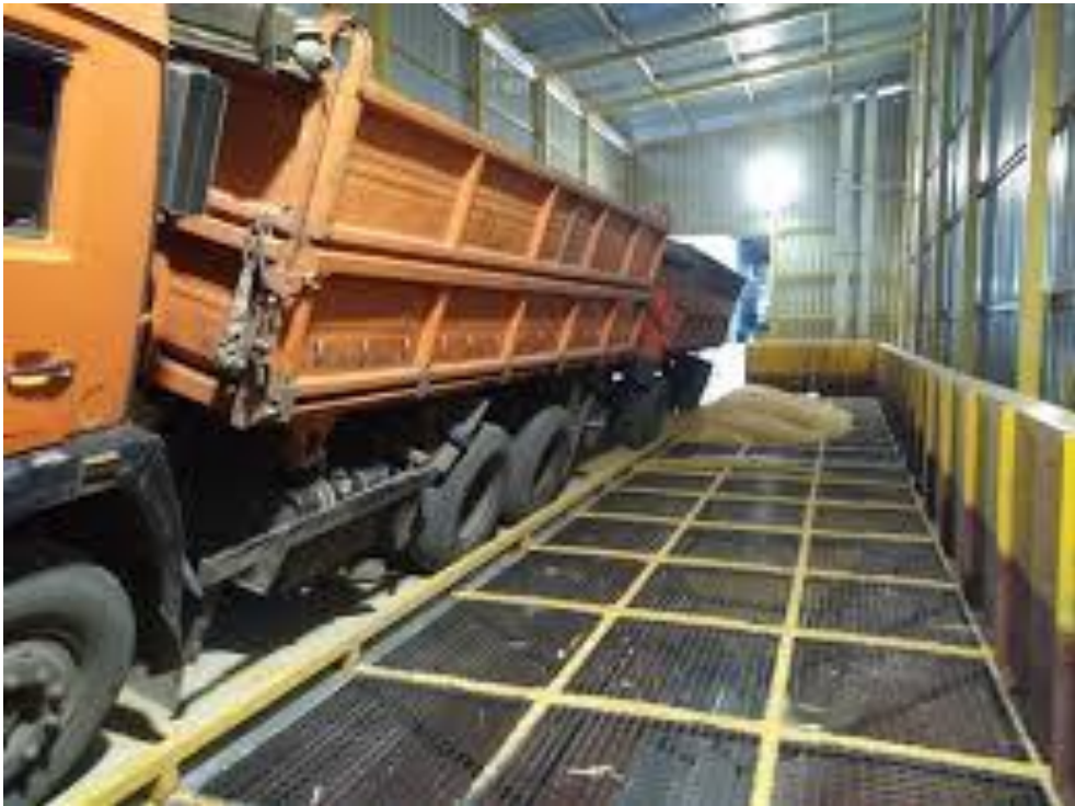
Рис. 7.2. Розвантаження зерна з автомобіля з причепом шляхом поперечного нахилу
