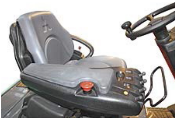
Рис. 3.36. Загальний вигляд електронних органів управління на новітніх моделях навантажувачів Mitsubishi [99]
