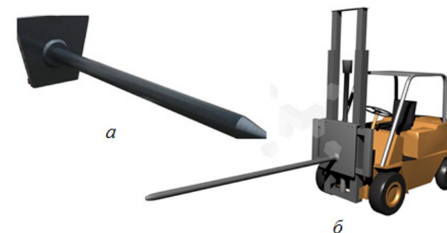
Рис. 3.59. Навісне обладнання для транспортування вантажів циліндричної форми: а – загальний вигляд штиря; б – встановлений штир на навантажувачі
