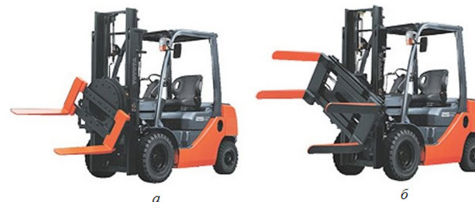
Рис. 3.54. Навантажувачі з поворотним захватом з вилами: а – з однієї сторони; б – з двох сторін
