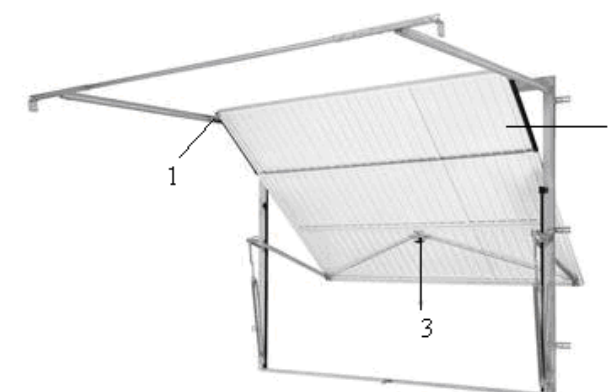
Рис. 3.22. Основні елементи конструкції підйомних (щитових) воріт:
