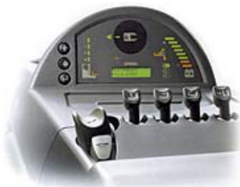
Рис. 3.38. Клавішні важелі системи управління ричтрака 4500 Crown [99]
